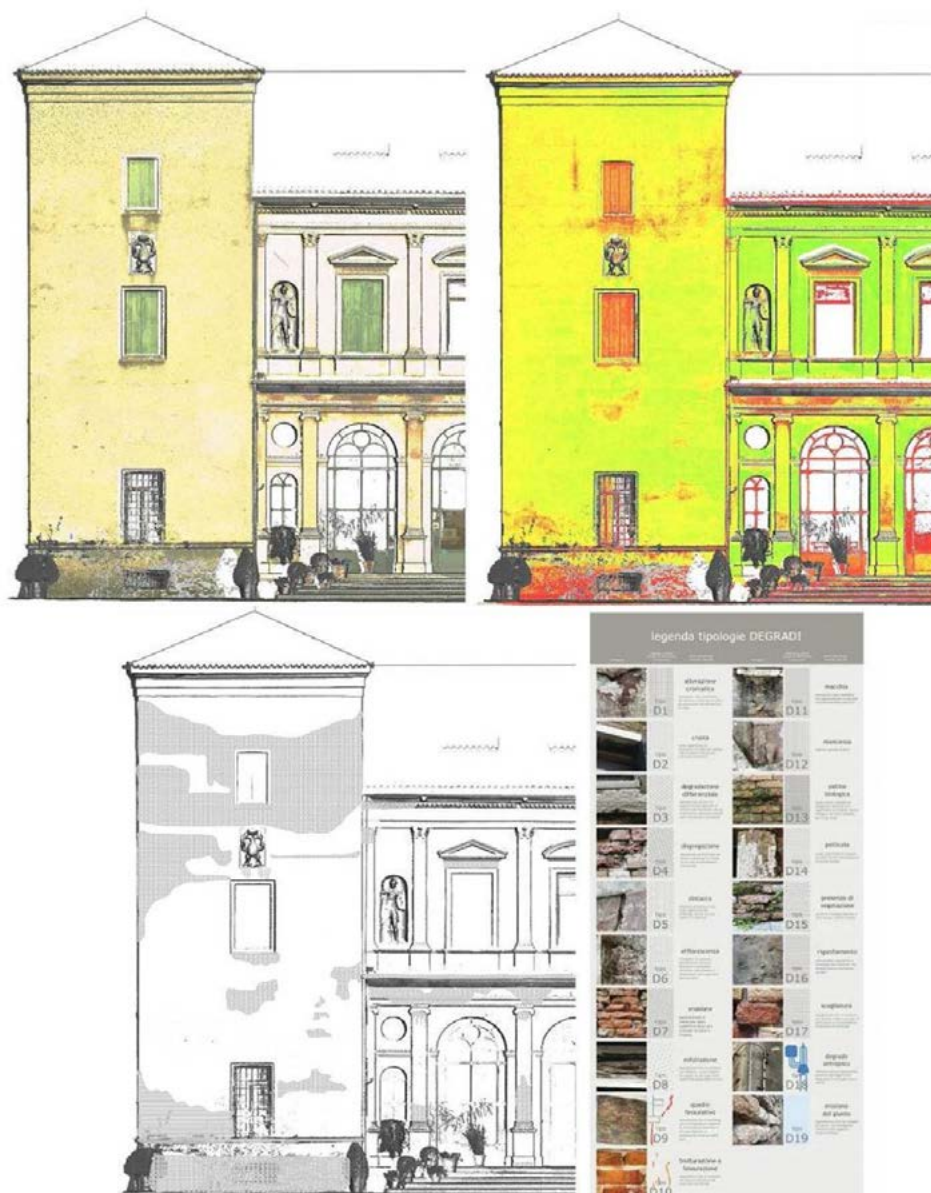
Figura 4 –Villa Trissino a Cricoli: fronte sud. Disegni 2D di mappatura del degrado
